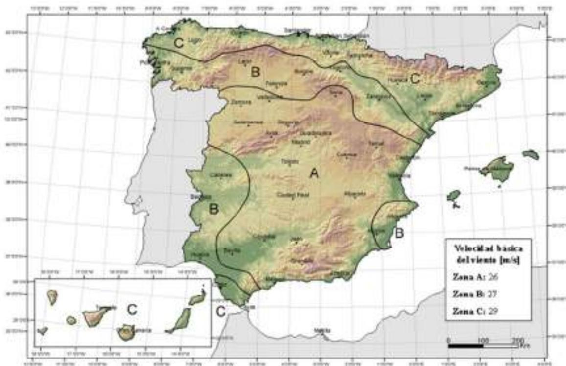
El coeficiente de exposición,  $c_e$ , será de 2,5 según la Tabla 3.4 del SE-AE, de acuerdo a una altura de 6 metros y un Grado II de aspereza del entorno (Terreno rural llano sin obstáculo ni arbolado de importancia).
